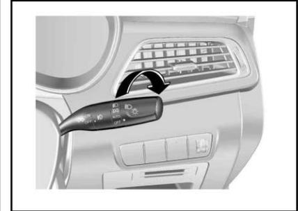
Untuk menyalakan atau memadamkan lampu utama, lampu belakang, dan lampu posisi, putar ujung combination switch lever.
