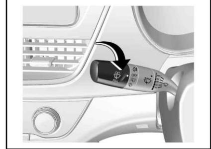
Untuk menggunakan wiper bagian belakang, pastikan pintu bagasi dalam keadaan tertutup dengan sempurna, kemudian atur ignition switch ke posisi ON, putar knop switch wiper dan washer belakang ke posisi
