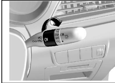
Jika kendaraan dilengkapi dengan lampu kabut depan, atur bagian tengah combination switch lever ke posisi ON untuk menyalakan lampu kabut depan saat lampu utama berada pada posisi lampu dekat atau dalam kondisi lampu posisi. Putar ring ke posisi OFF untuk mematikan lampu kabut depan.
